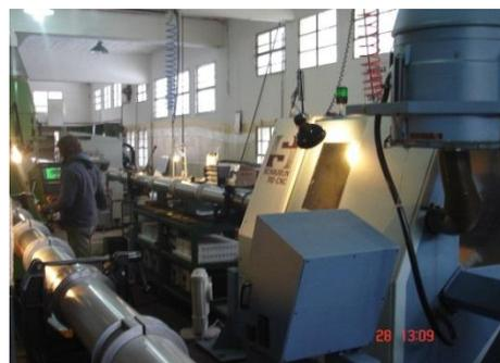
**HAAS** – Modelo: **SL 10 T** – Origen USA – Tipo CNC –Características: Torno CNC, comando sobre ejes X Z, resolución en eje X 0.005mm – eje Z 0.005 mm, pasaje de barra max 44 mm, diam max. Torneable 165 mm, desplazamientos ejes X 159 mm – eje Z 356 mm. 6000 rpm [Cantidad: 2]
