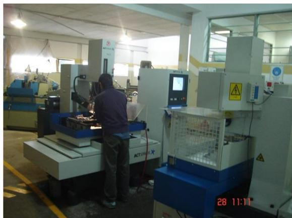
**ACT SPARK** – Modelo: **SP1** - tipo: de penetración Origen: China – Características: ejes X Y Z mm 320x250x250 max kg 400 kg [Cantidad: 1 ] (incorporación. Oct 2008)
